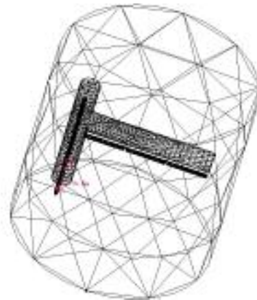
شکل ۳ - شبکه بندی محیط مسئله برای حل عددی مثال (۱)
