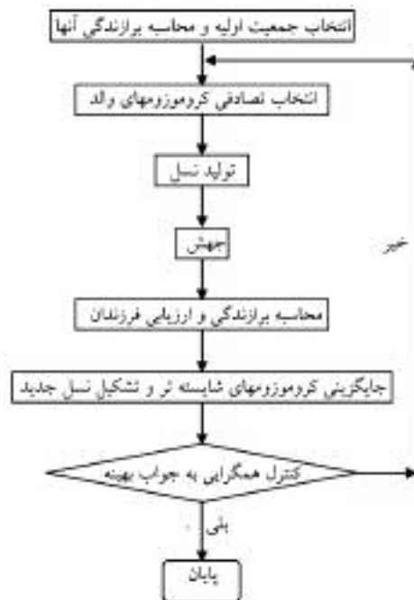
شکل ۲ - فرایند به کارگیری الگوریتم ژنتیک
