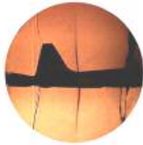
شکل ۳-ب) حرکت موج ناپایا در انتهای مدل با یک دم عمودی بعد از گذشت زمان، \alpha=0
