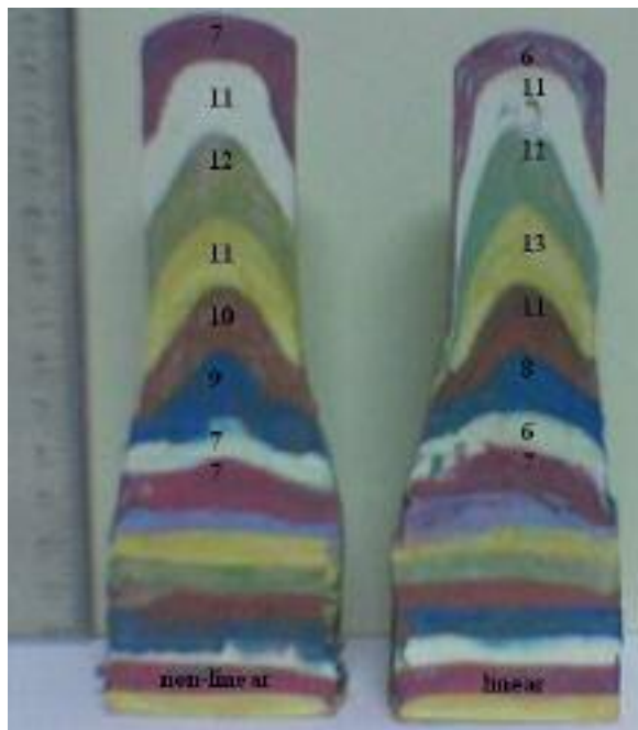
شکل ۲۰ - ضخامت لایه‌ها بر روی محور اکستروژن
