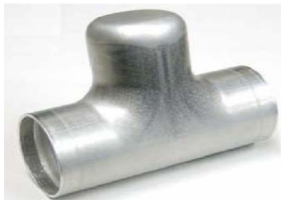
شکل ۲- لوله تغییر شکل یافته در انتهای فرایند هیدروفرمینگ بعد از
