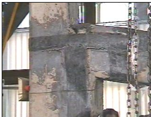
شکل ۸- جدا شدگی ورقه U شکل روی ستون و پاره شدگی دورپیچ تیر و کربل در نمونه Base-P2
