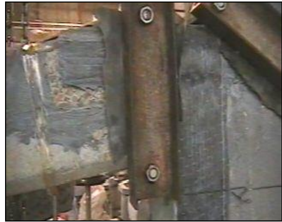
شکل ۹- جدا شدگی انتهای ورقه U شکل در نمونه Base-P3
