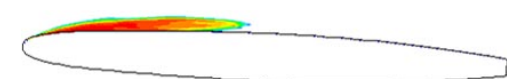
شکل ۱۱- ضریب فشار و شکل حباب هیدروفویل بریده شده MOD-NACA0009 ، زاویه حمله ۲/۵ و عدد کاویتاسیون ۰/۷۵
