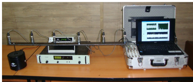
شکل ۴- تصویر آزمون آزمایشگاهی تیر فولادی
