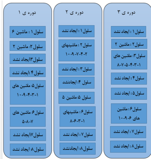
شکل ۱۲- شمای شماتیک از قرارگیری ماشین آلات در سلول‌های تشکیل شده در دوره ۳ با افزایش هزینه جابه‌جایی ماشین شماره ۲
