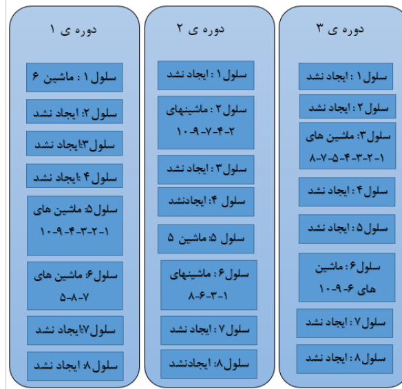
شکل ۱۱- شمای شمانیک از قرارگیری ماشین آلات در سلول های تشکیل شده در دوره ۳
