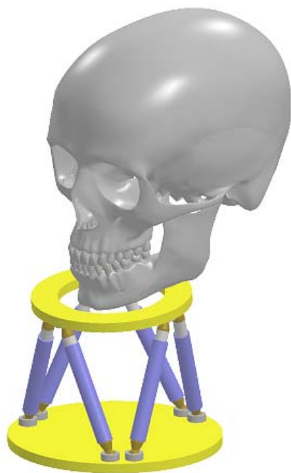
شکل ۱۰- روبات استوارت به‌عنوان روبات جویدن
