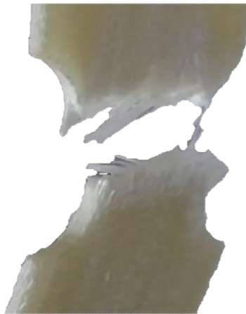
شکل ۱۹- نمونه حلقوی بافته شده پس از تخریب
