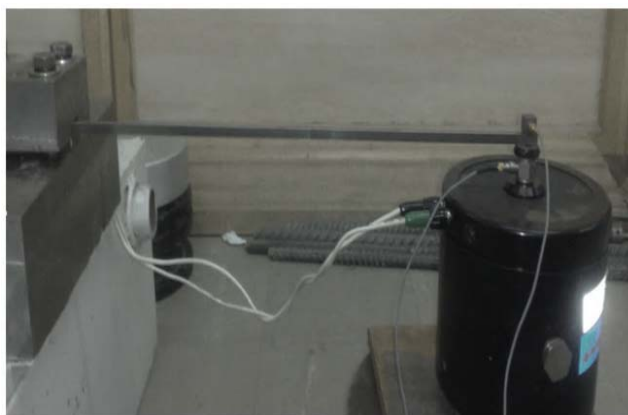
شکل ۳- تیر یک سر گیردار تحت آزمایش
