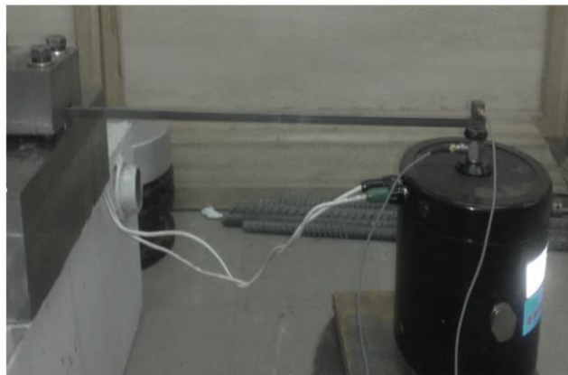
شکل ۳- تیر یک سر گیردار تحت آزمایش
