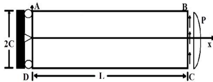
شکل ۳- شرایط حاکم بر تیر طره تحت نیرو با توزیع سهمی گون در انتهای آزاد
