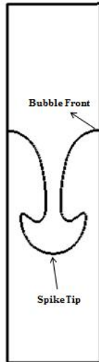
شکل ۷- محل اندازه‌گیری پارامترهای Spike Tip و Bubble Front
