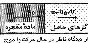
شکل ۴- سرعت گازهای حاصل از انفجار از دیدگاه ناظر ساکن و ناظر متصل به موج
