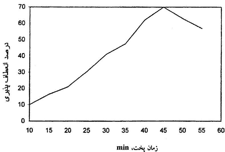
شکل ۵- تأثیر زمان پخت بر انعطاف پذیری در دمای پخت 230^{\circ}\text{C} درصد وزنی پایدارکننده ۰/۵، زیر لایه فسفات روی، زبری سطح سنباده 110 ، دمای پخت 230^{\circ}\text{C} .
