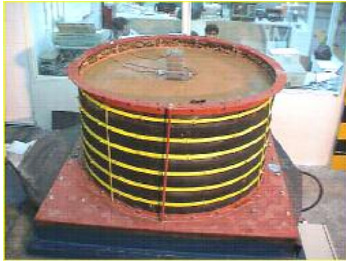
شکل ۱۸- نمایی از آزمایشهای اندرکنش خاک-سازه منفرد
