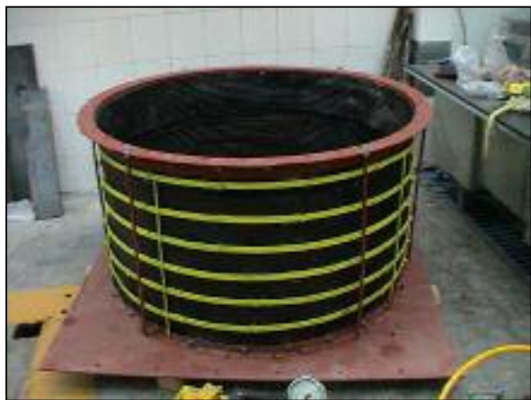
شکل ۱۰- نمایی از ظرف مدل خاک ساخته شده
