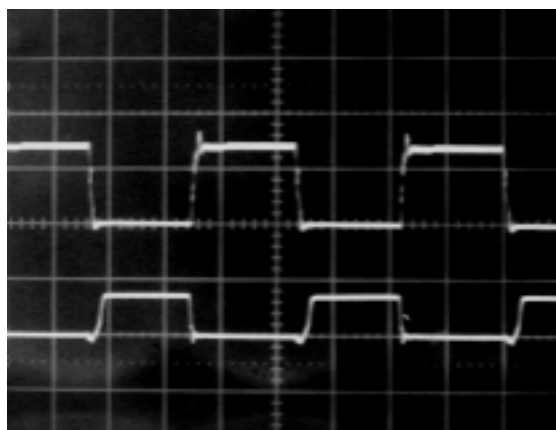
شکل ۱۰- ولتاژ گیت سورس (پائینی) و درین سورس و درین سورس (بالایی) کلیدهای پسفاز
