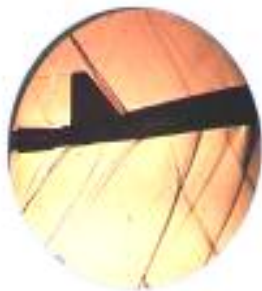
شکل ۳-ح) حرکت موج ناپایا روی بخش انتهای مدل با دم عمودی دوتایی، \alpha=6
