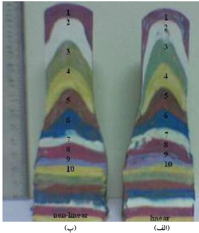
شکل ۱۹ - مقطع برش خورده نمونه‌های تغییر شکل یافته با استفاده از قالب خطی (الف) و قالب غیرخطی بهینه (ب)
