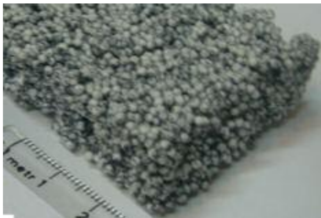
شکل ۲- مدل فومی آغشته EPS/SiC p تولید شده توسط ملاط فومی پس از قالبگیری و خشک.
