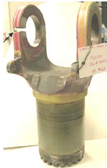
شکل ۱۸- نمونه تجربی اسپیندل پس از شکست [۲۸]
