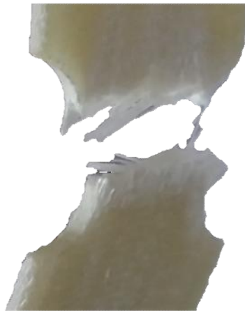
شکل ۱۹- نمونه حلقوی بافته شده پس از تخریب
