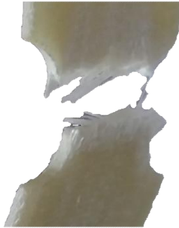
شکل ۱۹- نمونه حلقوی بافته شده پس از تخریب
