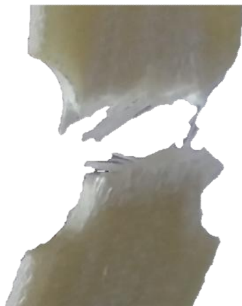
شکل ۱۹- نمونه حلقوی بافته شده پس از تخریب
