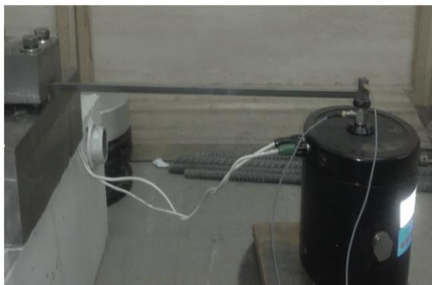
شکل ۳- تیر یک سر گیردار تحت آزمایش
