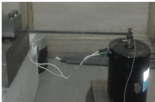
شکل ۳- تیر یک سر گیردار تحت آزمایش
