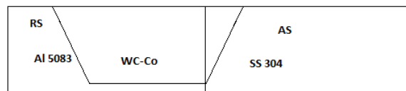
شکل ۹- شماتیک ابزار و نحوه آفست دهی در حین جوشکاری قطعات
