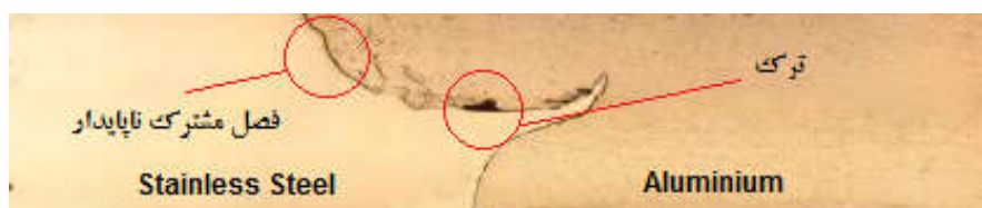
شکل ۱۱- مقطع عرضی اتصال فولاد زنگ‌نزن به آلومینیوم در سرعت چرخشی ۳۵۰RPM و خطی ۸۰ mm/min
