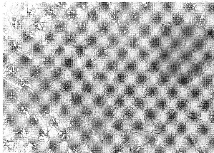
شکل ۹ - ساختار میکروسکوپی آلیازی با یک درصد مس که درد مای ۳۷۵°C بمدت ۱۵۰ دقیقه آستمپرشده است. ساختار حاوی آستنیت با قیمانده (فاز روش) و بینیت بالائی (فاز تیره) میباشد. محلول ظاهرکننده : نایتال ۲٪ بزرگ نمایی : ۴۰۰ برابر
