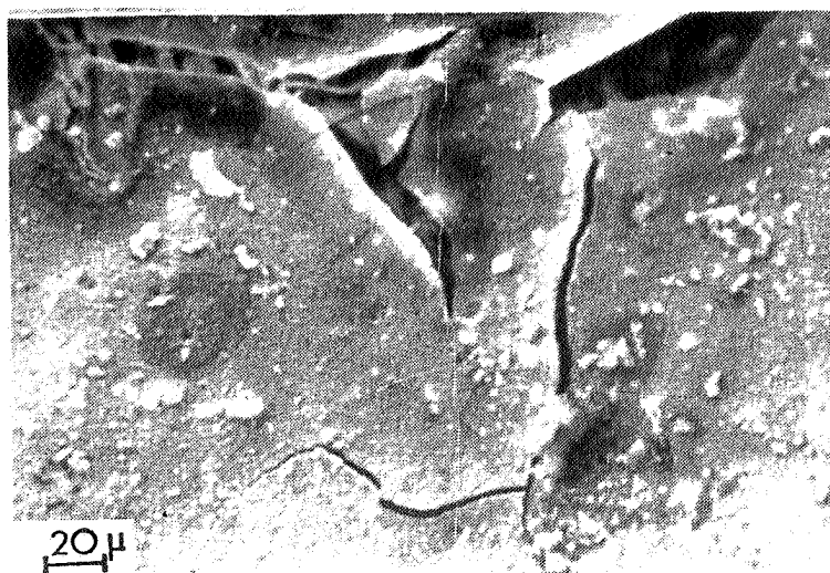
شکل ۱۵ : تصویر میکروسکوپی الکترونی از رسوبات ضخیم و غنی از آرسنیک که بر روی سطح نمونه خوردگی تنشی تشکیل شده و ترک خورده اند . محلول : محلول پایه حاوی 500ppm آرسنیک سرعت کشش : 3/3 \times 10^{-2} میکرون بر ثانیه
