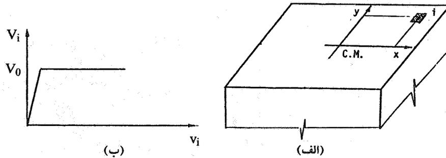
شکل ۳ - جزء  $i$  همراه با منحنی نیرو - جابجایی آن
