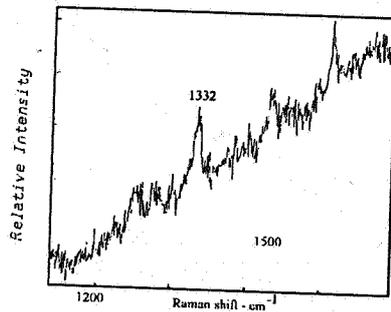
شکل ۳ - پوشش تشکیل شده در نسبت اکسیژن به استیلن برابر ۸/۰
