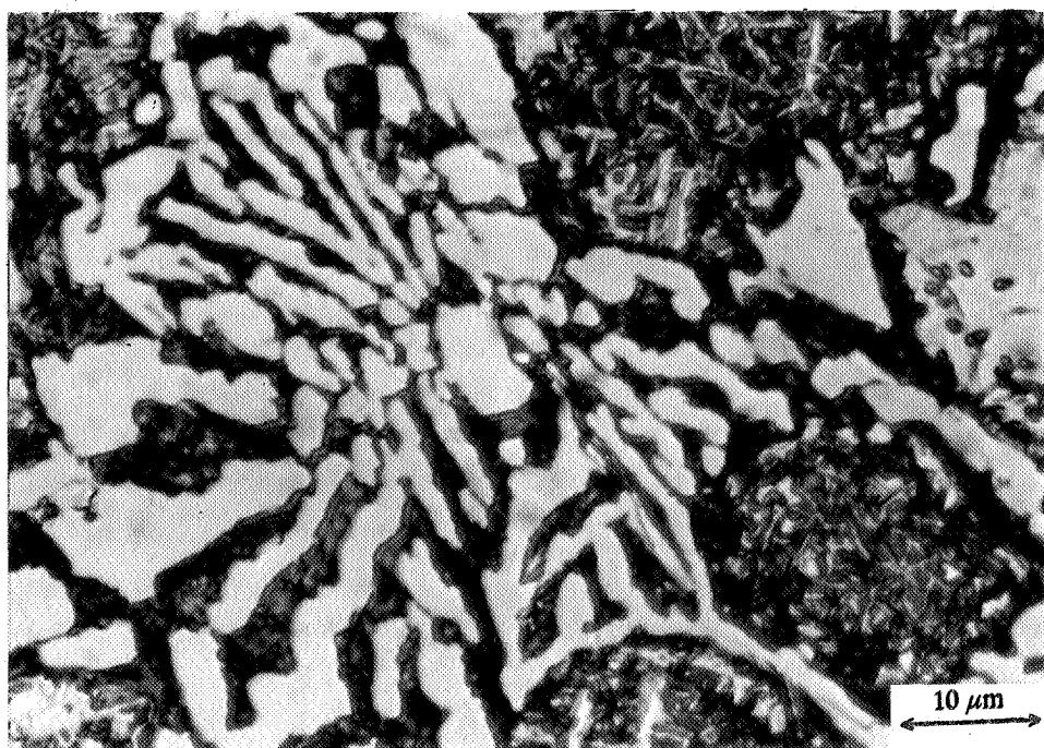
شکل ۲- ساختار میکروسکوپی چدن نیکل سخت عملیات حرارتی شده با  $2/3$  درصد کربن شامل زمینه مارتنتزیت و فاز کاربید
