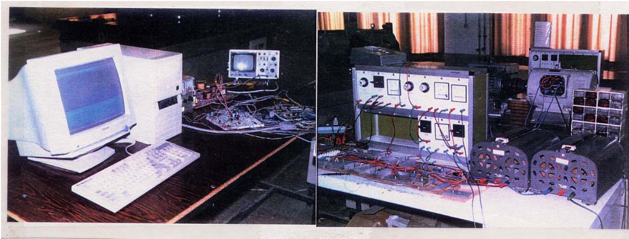
شکل ۵- درایو موتور رلکتانسی سوئیچ شونده
