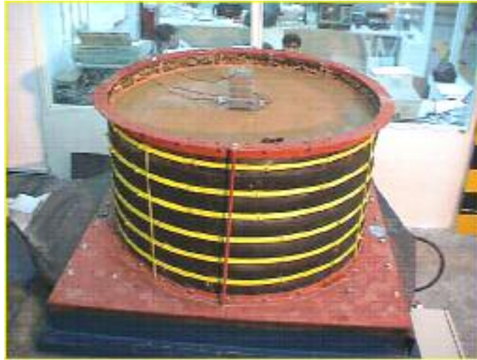
شکل ۱۸- نمایی از آزمایشهای اندرکنش خاک-سازه منفرد
