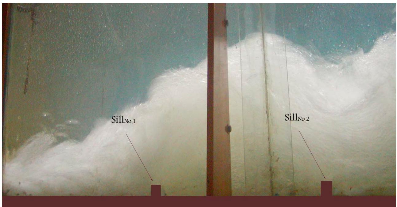
شکل ۲۵- چگونگی تشکیل جریان در حالت ترکیبی از دو دیواره ( $Q = 61/83 \text{ L/sec}$ )  $s_2 = 30 \text{ mm}$ ,  $s_1 = 20 \text{ mm}$  و  $s_1 = 30 \text{ mm}$
