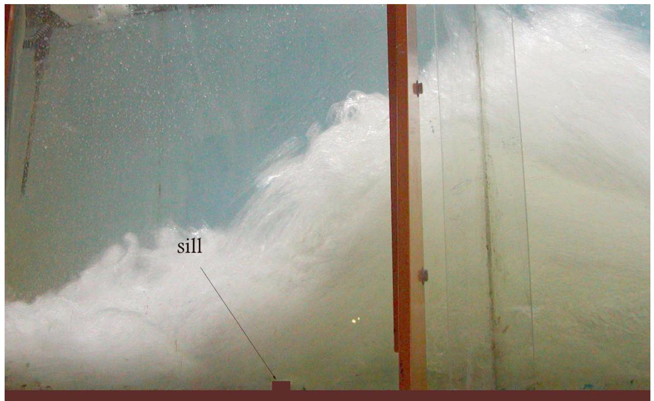
شکل ۱۴- چگونگی تشکیل جریان در حالت یک دیواره  $s_1 = 20 \text{ mm}$
