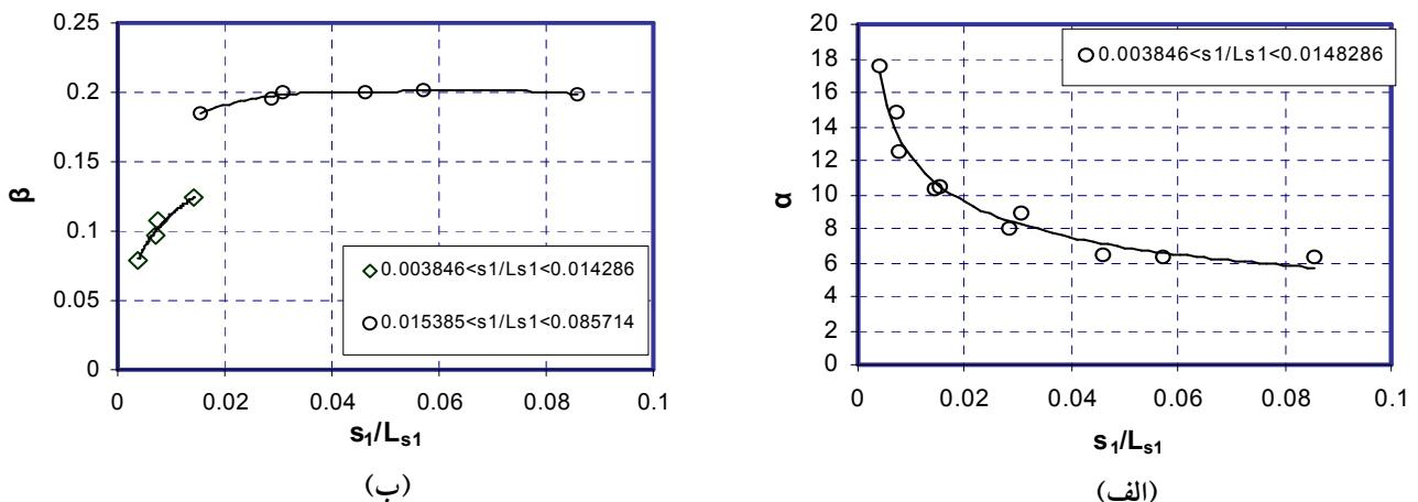
شکل ۱۶- رسم تغییرات ضرایب  $\alpha$  و  $\beta$  به صورت تابعی از  $s_1/L_{s_1}$  در حالت یک دیواره به صورت تابع نمایی زیر است:
