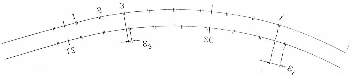
شکل ۴ - افزایش جابه‌جایی درزها در قوسها
