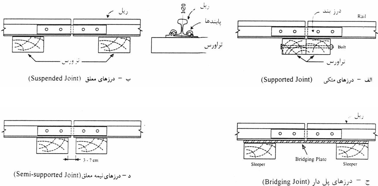
شکل ۱- انواع درزهای بین دو ریل [ ۶، ۸ ]
