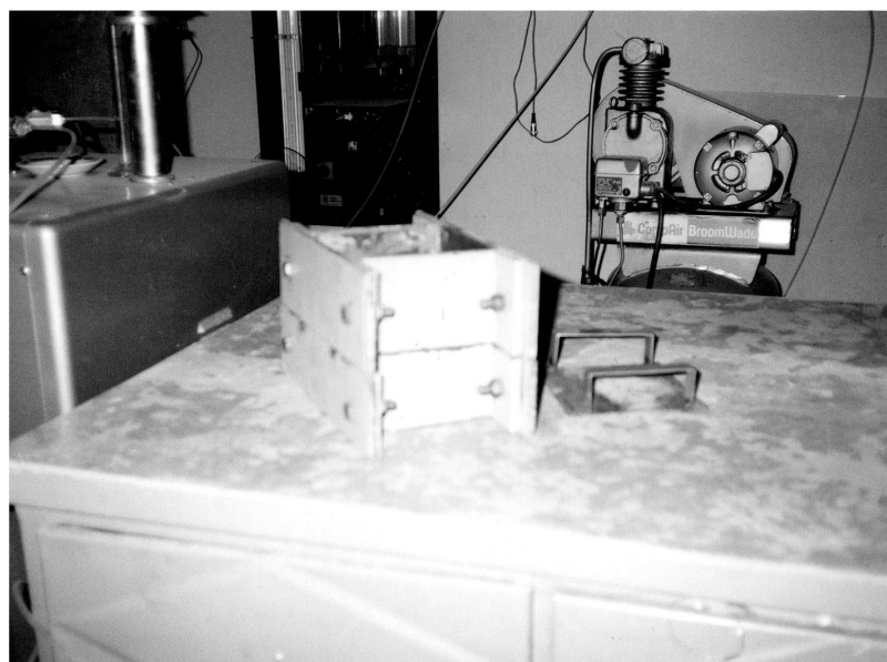
شکل ۴- نیم‌جعبه‌های مورد استفاده در آزمایش برش مستقیم
