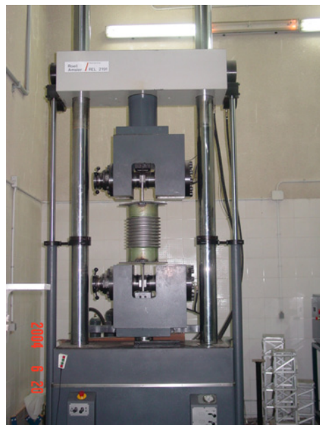
شکل ۴- آرایش آزمایش و دستگاه هیدرولیکی کشش و فشار دینامیکی
