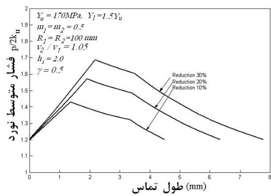
شکل ۱۶- چگونگی توزیع فشار متوسط برای کاهش ضخامت‌های مختلف و برای  $Y_u = 1.5Y_l$
