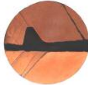
شکل ۳-ج) موج ناپایا روی بخش انتهای مدل با یک دم عمودی، \alpha=0
