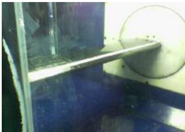
شکل ۳ - مدل داخل محفظه آزمایش تونل باد
