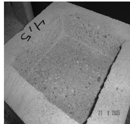
شکل ۳- نمونه آزمایش کشش مستقیم
