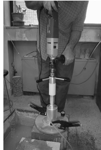
شکل ۴- مغزه گیری از نمونه
