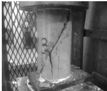
شکل ۲- آزمایش برش مایل
