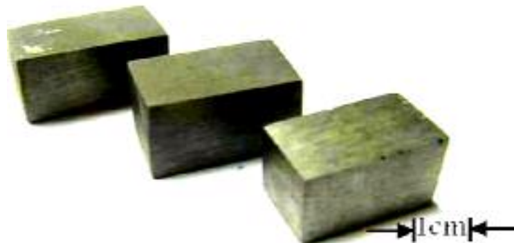
شکل ۱۴- نمایی از نمونه‌های استاندارد محاسبه دانسیته.
