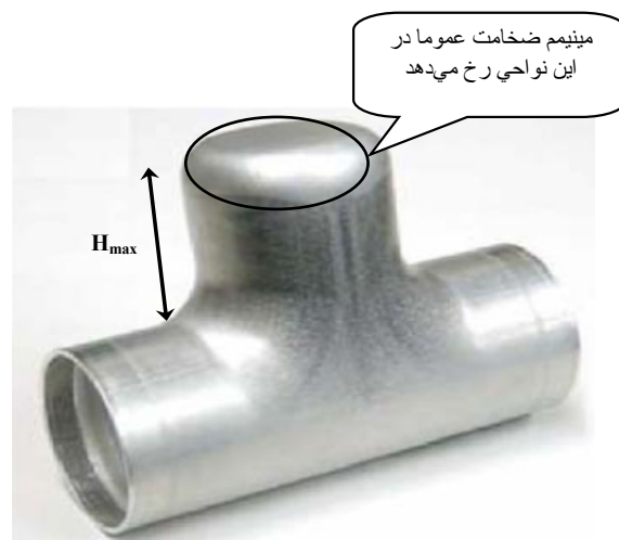
شکل ۷- معیارهای شکل‌پذیری در هیدروفرمینگ اتصالات T شکل
