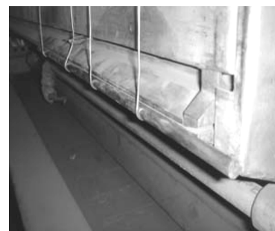
شکل ۲۷- نمای جانبی استوانه‌ها با دو قطر متفاوت ، نمایی از محل قرارگیری استوانه در لبه زیرین جت و نحوه بستن استوانه به لبه زیرین یکی از جتها
