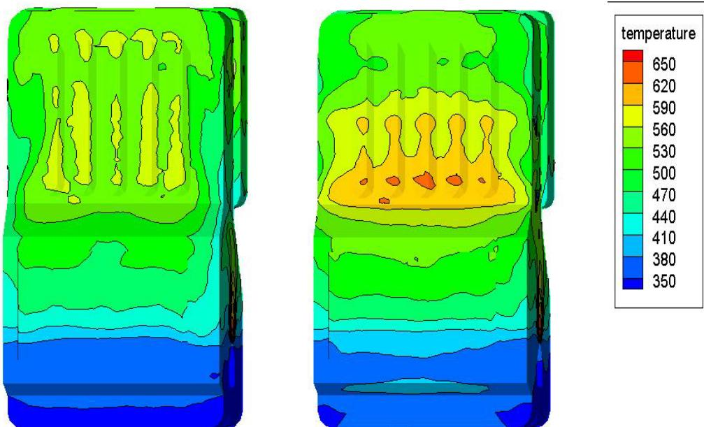
شکل ۱۱- توزیع دما (درجه کلوین) روی تنوره داخلی در دو حالت با مانع (شکل سمت راست) و بدون مانع (شکل سمت چپ)
