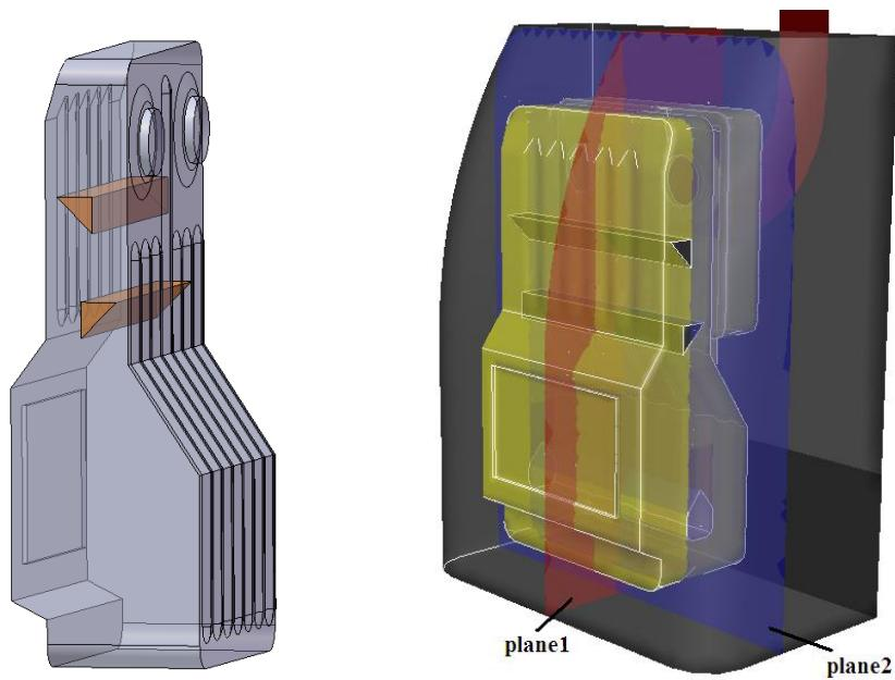
شکل ۹ - نمای شماتیک بخاری با موانع در جهت عمود بر جریان سیال
