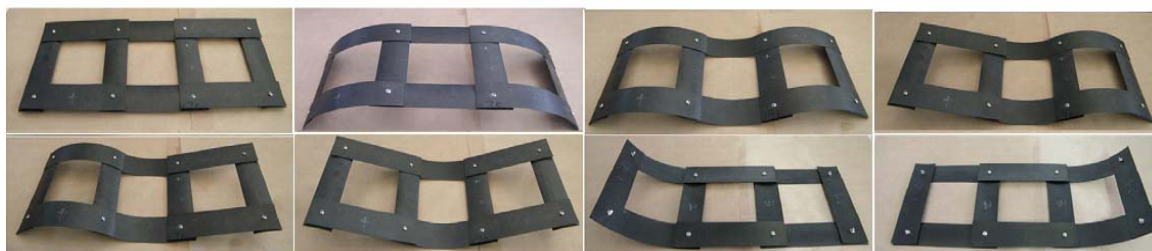
شکل ۲- سازه مورفینگ دارای هشت حالت پایدار [۶]
