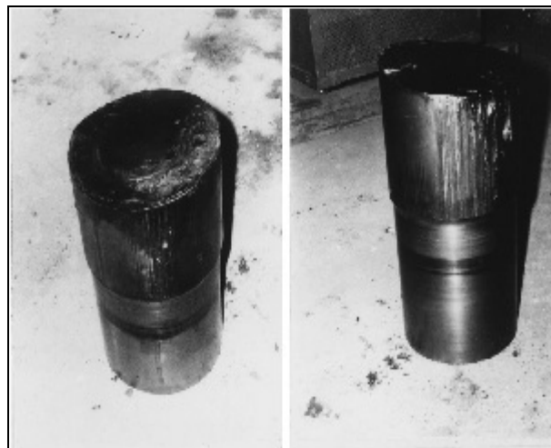
شکل ۱- نمونه‌ای از شکست محور قطار در نتیجه خستگی سایشی [۱]
