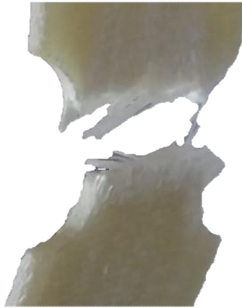
شکل ۱۹- نمونه حلقوی بافته شده پس از تخریب
