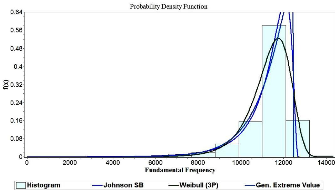
شکل ۱۱- هیستوگرام پاسخ‌های پیش‌بینی شده با استفاده از مدل جانشین کریجینگ
