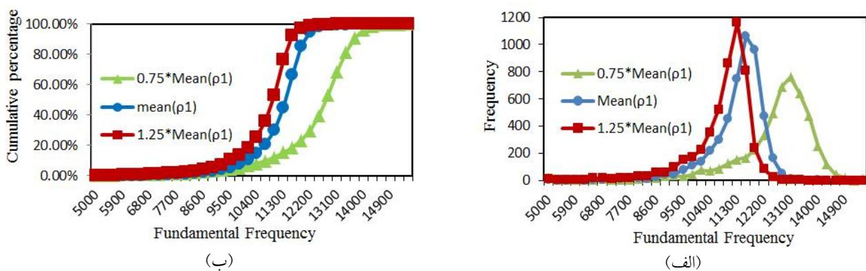
شکل ۱۴- نمودارهای: (الف) توزیع فراوانی و (ب) توزیع تجمعی، برای بسامدهای مود اول پیش‌بینی شده با استفاده از مدل جایگزین کریجینگ برای مقادیر  $\mu_{\rho_1}, \mu_{\rho_1}, \mu_{\rho_1}$  از پارامتر چگالی لایه اول ( $\rho_1$ ).
