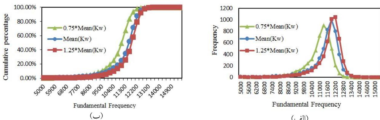
شکل ۱۳- نمودارهای: (الف) توزیع فراوانی و (ب) توزیع تجمعی، برای بسامدهای مود اول پیش‌بینی شده با استفاده از مدل جایگزین کریجینگ برای مقادیر  $\mu_{K_w}, \mu_{K_w}, \mu_{K_w}$  از پارامتر سفتی برشی ( $K_w$ ).
