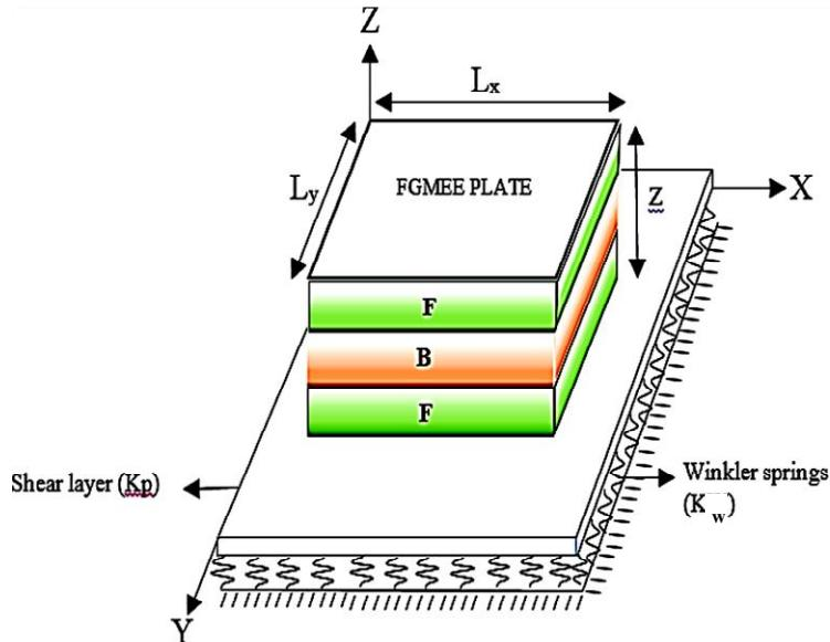
شکل ۱- طرح نمادین از ورق FGMEE چندلایه، روی بستر ارتعاشی دارای دو پارامتر سفتی عرضی و برشی،
