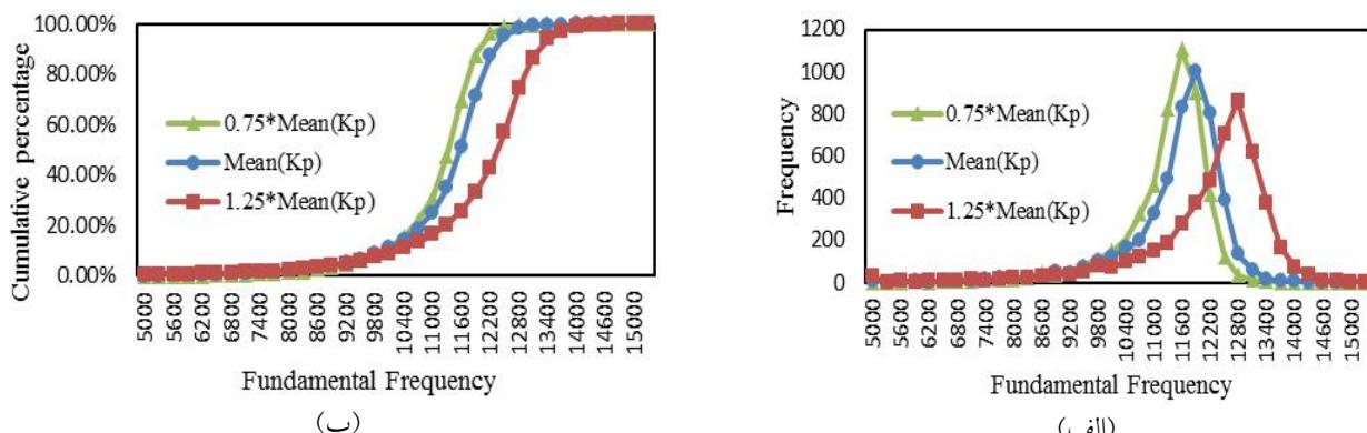
شکل ۱۲- نمودارهای: (الف) توزیع فراوانی و (ب) توزیع تجمعی، برای بسامدهای مود اول پیش‌بینی شده با استفاده از مدل جایگزین کریجینگ برای مقادیر  $\mu_{K_p}, \mu_{K_p}, \mu_{K_p}$  از پارامتر سفتی برشی ( $K_p$ ).
