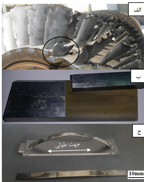
شکل ۱- الف) پره شکسته شده، ب) برشی از پره و ج) نمونه تنش دار و بدون تنش (رنگی در نسخه الکترونیکی)
